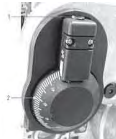
Fig. 7-5 Réglage de l'étranglement d'air
