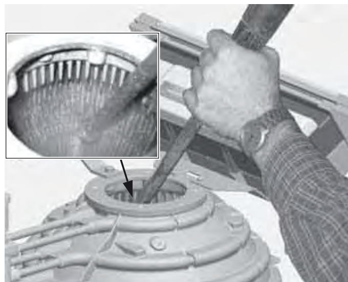
Fig. 9-15 Nettoyage de la chambre de combustion avec un nettoyeur haute pression
