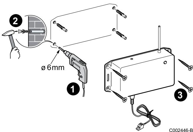
Moduł radiowy należy zamocować na ścianie w pobliżu generatora grzejnego, aby można było podłączyć go do konsoli sterowniczej. W tym celu wykorzystać dostarczone 4 śruby + 4 kolki.
