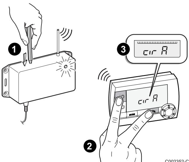
**1** Nacisnąć końcówką długopisu przycisk na module radiowym. Lampka sygnalizacyjna na module radiowym zapala się.
