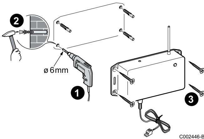
De radiomodule moet aan de muur, in de buurt van de verwarmingsgenerator worden bevestigd om aansluiting hiervan op het bedieningspaneel mogelijk te maken. Gebruik de 4 meegeleverde schroeven + 4 pluggen.
