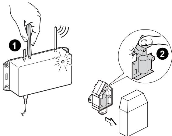
Ogni sonda esterna è dotata di serie di un numero di identificazione univoco che consente al modulo radio di riconoscerla. Tale identificativo viene trasmesso al modulo radio mediante la sequenza di sintonizzazione descritta a seguire.
