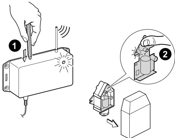
Iedere buitensor heeft standaard een uniek identificatienummer waarmee de radiomodule deze herkennen kan. Dit identificatienummer wordt aan de radiomodule doorgegeven door de hierna beschreven combinatisequentie.
