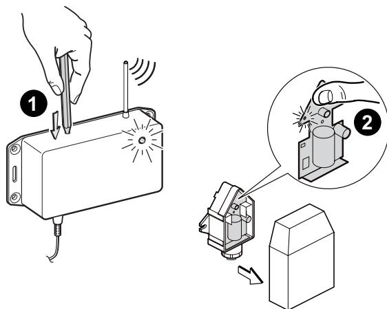
Каждый датчик наружной температуры имеет уникальный идентификационный номер, который позволяет радиопередатчику распознавать его. Этот идентификационный номер передается радиопередатчику во время цикла настройки радиопередачи, описанного далее.
