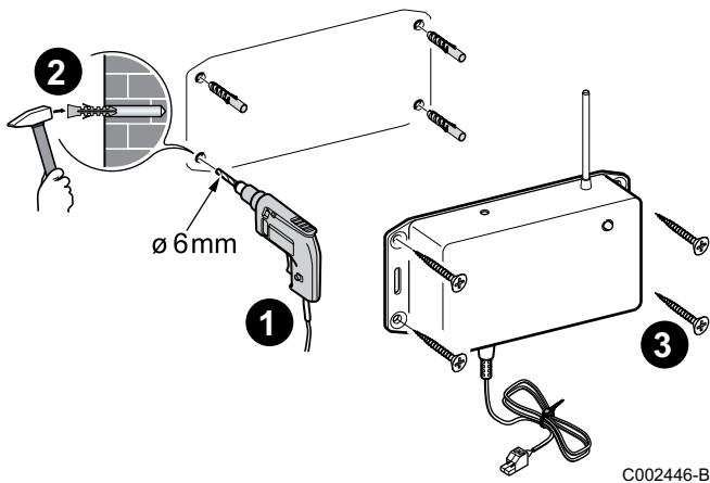
Das Funkmodul muss an der Wand in der Nähe des Heizgenerators installiert werden, damit das Schaltfeld an Letzterem montiert werden kann. Hierzu die beiliegenden 4 Schrauben + 4 Dübeln verwenden.
