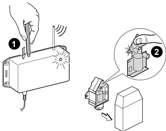
**1** Nacisnąć końcówką długopisu przycisk na module radiowym. Lampka sygnalizacyjna na module radiowym zapala się.
