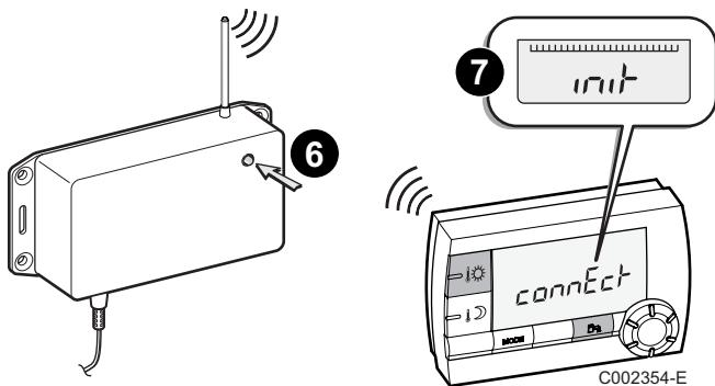
**6** **7** Po paru sekundach lampka sygnalizacyjna na module radiowym gaśnie, a na zdalnym sterowaniu wyświetlony zostaje komunikat "init" w trakcie synchronizacji z modelem.
