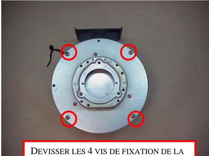
DEVISSER LES 4 VIS DE FIXATION DE LA PARTIE SUPERIEURE DE LA SOUFFLERIE
