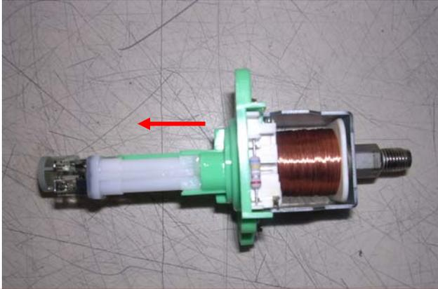
DECLIPSER DE CHAQUE COTE DE LA POMPE LE CONTROLEUR DE NIVEAU DE COMBUSTIBLE EN LE FAISANT PIVOTER DE HAUT EN BAS TOUT EN TIRANT DESSUS
