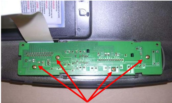
DEVISSER LES 4 VIS DE FIXATION DE LA PLATINE.
