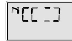
*Lors d'une action du débistat sanitaire (Débit > 1,9 l/min)* les signaux de forme carrés défilent deux par deux.
