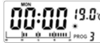
PROG 3: Mode Confort de 6h à 8h, de 11h à 13h et de 16h à 23h
