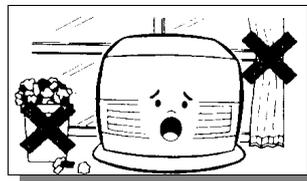
Éteignez toujours l'appareil avant de le remplir de combustible liquide pour appareil mobile de chauffage. Nettoyez soigneusement toutes les gouttes de combustible liquide pour appareil mobile de chauffage. Ne remplissez pas votre appareil de combustible liquide pour appareil mobile de chauffage dans la pièce pour éviter toute incendie.
