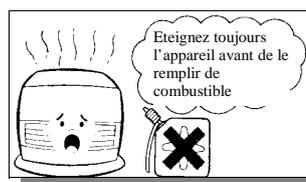
Lorsque vous utilisez l'appareil, aérez la pièce au moins une à deux fois par heure et durant une à deux minutes à chaque fois. N'utilisez jamais l'appareil sans aérer convenablement la pièce dans laquelle il se trouve. Une oxygénation insuffisante peut être à l'origine d'une mauvaise combustion et créer des émanations de monoxyde de carbone hautement toxiques.
