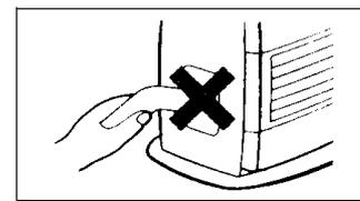
Faites en sorte de ne jamais obstruer le système de ventilation de l'air chaud, que ce soit avec du papier ou des vêtements.
