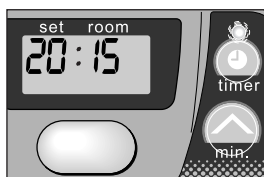
G: La lampe témoin TIMER indique que la fonction timer est active.
