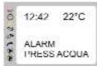
Action du pressostat de contrôle de pression d'eau, arrêt de l'appareil si la pression descend en dessous de 0,7 bar ou dépasse 2,5 bar
