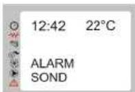
Panne du capteur de fumées, arrêt de l'alimentation en combustible et refroidissement de l'appareil , extracteur et ventilateur fonctionne à la vitesse maxi
