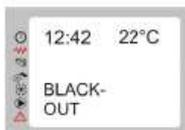
En cas de panne de courant pendant plus de 1' arrêt de l'alimentation en combustible et refroidissement de l'appareil , extracteur et ventilateur fonctionne à la vitesse maxi
