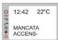
Si l'appareil a loupé son cycle allumage automatique ou si la température des fumées descend en dessous de la valeur mini pré-réglé, arrêt alimentation en combustible et refroidissement de l'appareil , extracteur et ventilateur fonctionne à la vitesse maxi
