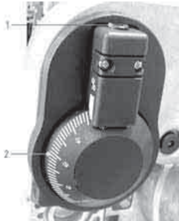
Afb. 7-5 Instelling van het luchtsmoorventiel
